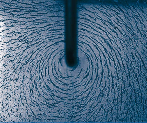
Feine Eisenspäne machen bei einem stromdurchflossenen Leiter die magnetischen Feldlinien sichtbar.
